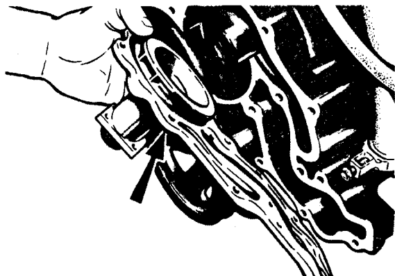
Рис. 2.8. Снятие водяного насоса (указан стрелкой) - двигатели V 6.
