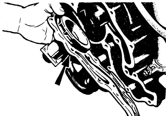
Рис. 2.8. Снятие водяного насоса (указан стрелкой) - двигатели V 6.
