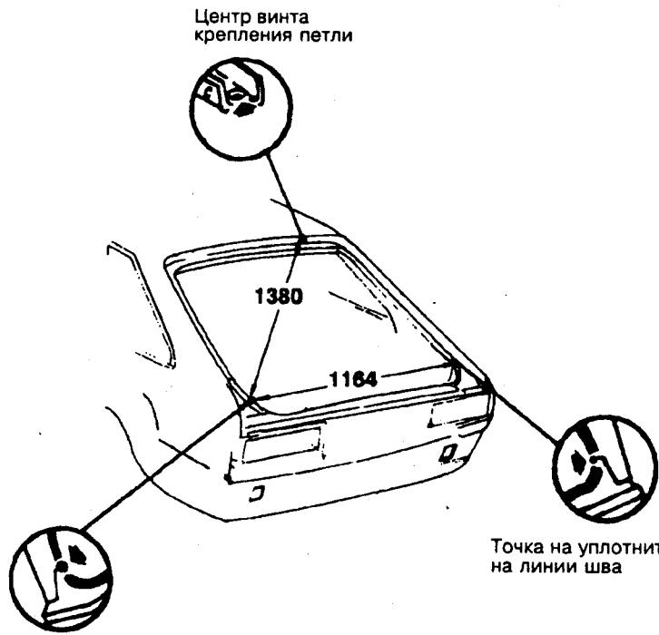
Точка на уплотнителе на линии шва
